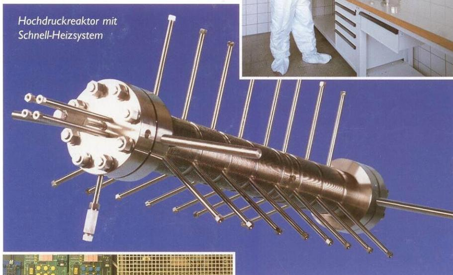
Hochdruckreaktor mit Schnell-Heizsystem
