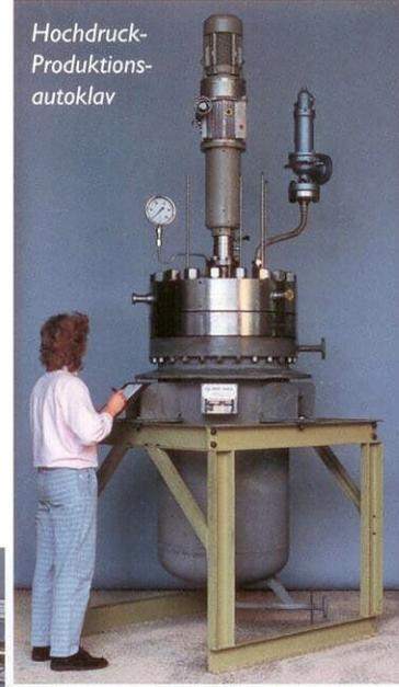
Hochdruck-autoklav mit pneumatisch aufklappbarer Heizung
