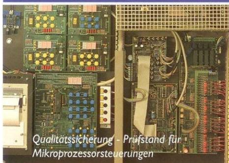
Qualitätssicherung - Prüfstand für Mikroprozessorsteuerungen
